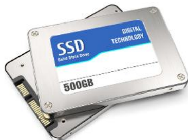
Unidade de Estado Sólido (SSD): dispositivo de armazenamento permanente que utiliza memória eletrônica para guardar arquivos, sendo mais rápido e silencioso que o HD. Foto de 2019.
