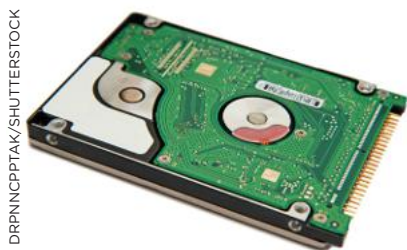
Disco Rígido (HD): dispositivo de armazenamento permanente que utiliza discos magnéticos para guardar arquivos, como textos, fotos e vídeos, mesmo quando o computador está desligado. Foto de 2015.
